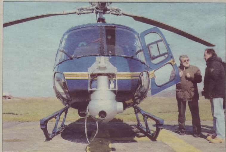
La caméra thermique qui permet de « photographier » et visualiser les déperditions de chaleur est située à l'avant de l'appareil.
