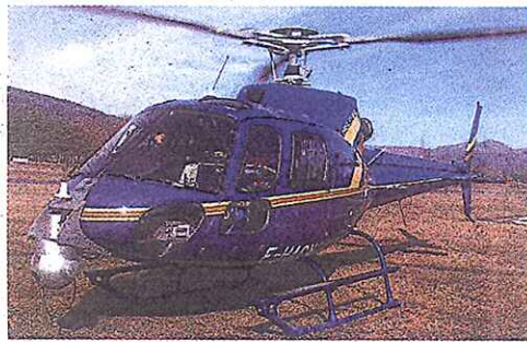
La thermographie a été réalisée en hélicoptère. La caméra thermique se trouve dans la boule, au nez de l'appareil.
