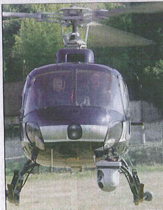
Pendant près de trois semaines, cet hélicoptère sillonne l'ensemble du territoire de la Casa, d'Antibes à Caussols, pour mesurer les déperditions thermiques du moindre bâtiment. (Photos Cyril Doderigny)
